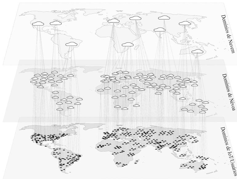
**Figure 5.9. Arquitetura Horizontal do Sistema de Névoa.**
